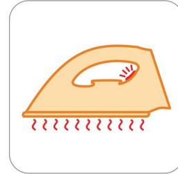
El piloto de temperatura se enciende cuando la plancha se está calentando y se paga cuando la temperatura de la suela llega al nivel establecido.
