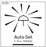
WAARSCHUWING! In de Vakantiefunctie wordt de instelling van de "Fruit&Veg, Quick cool, 0°C fresh" pictogrammen in Myzone uitgeschakeld en de temperatuur van Myzone kan niet worden aangepast. Het koelvak en Myzone verschijnen in de vorige instelling wanneer u de vakantiefunctie verlaat.
