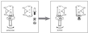
6. Vuelva a colocar el soporte colocando el perno de la bisagra inferior. Reemplace ambos pies ajustables.
